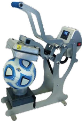
2. Schließen Sie den Handgriff bis die Heizplatte den Ball berührt, entriegeln Sie dann die Ball Halterung indem Sie den Feststellhebel gegen den Uhrzeigersinn drehen.
