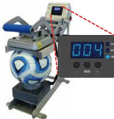
6. Produkte mit rauen Oberflächen (wie z.B. Basketbälle) müssen mit einer Grip Gummimatte nachgepresst werden.
