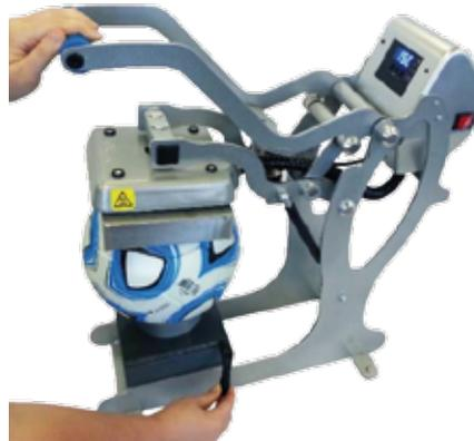
3. Nutzen Sie den Griff um die Ball-Halterung nach oben oder unten zu bewegen um den Anpressdruck zu regulieren. Die meisten Bälle sind am Besten zu bedrucken, wenn der Abstand zwischen dem Elektromagnet und der Stahlplatte am Handgriff ca. 5 cm beträgt.
