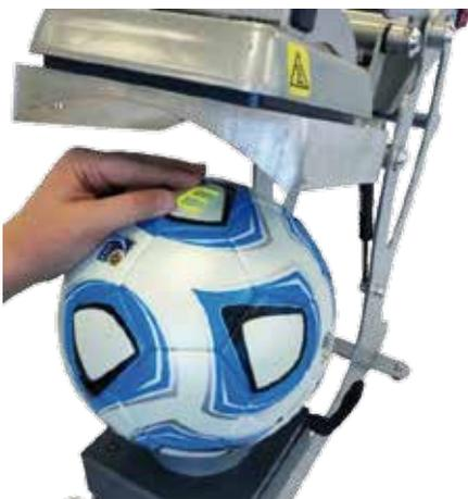
5. Bewegen Sie den Handgriff nach unten um die Presse zu schließen. Der Timer zählt automatisch die eingestellten Sekunden ab und gibt nach Ablauf der Zeit ertönt ein Signalton. Wenn die Presse geöffnet wird setzt sich der Timer automatisch wieder zurück und die Presse ist für den nächsten Andruck bereit.
