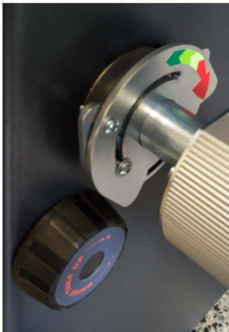
Bremsen und Rutschkuplungen für alle Achsen
