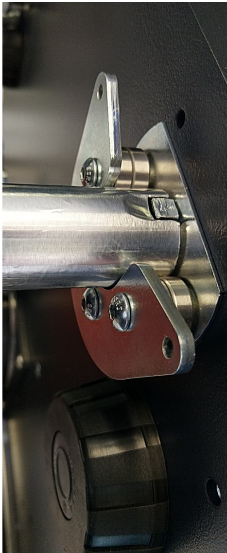
Antrieb über Bolzen-Nute-Verbindung
